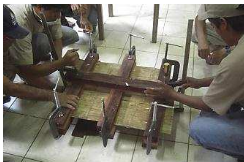
64. Fabricación de contraplacado
